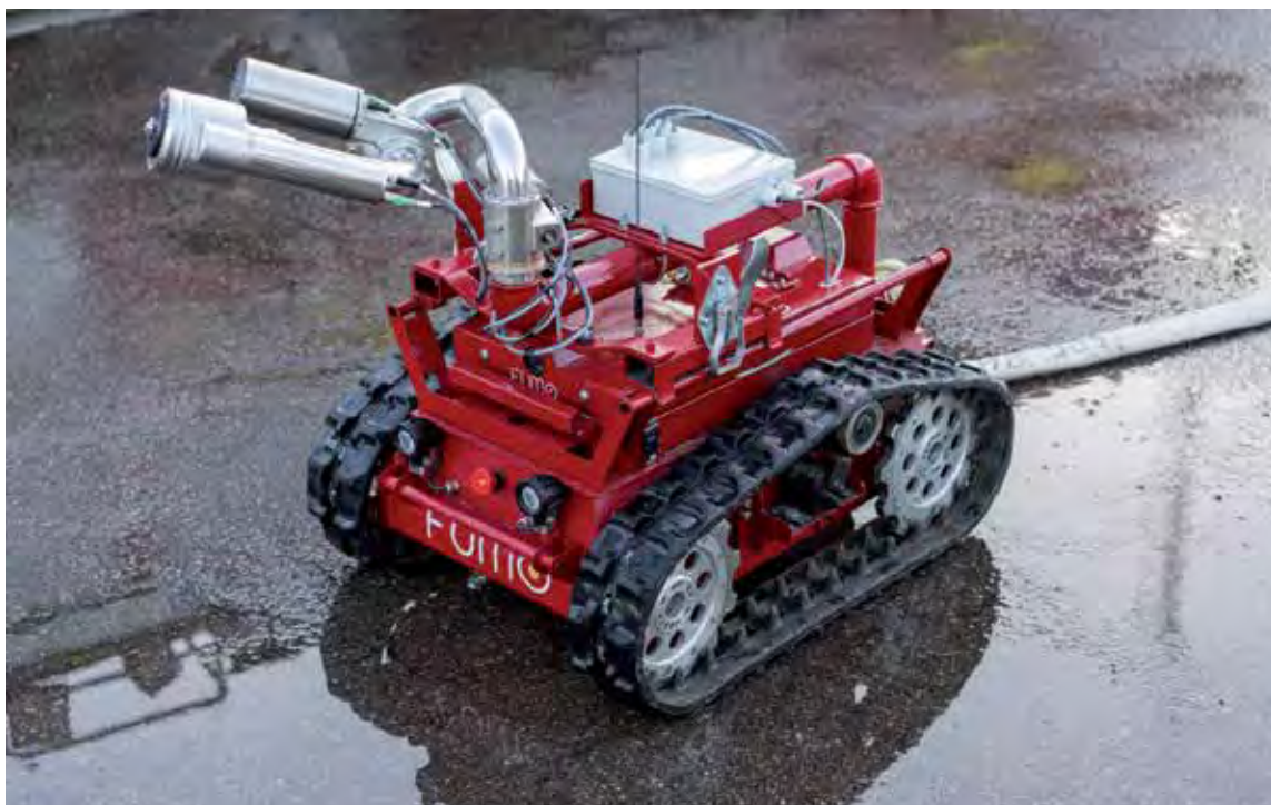
Brandroboten Fumo med släcklavett och grovslang.
